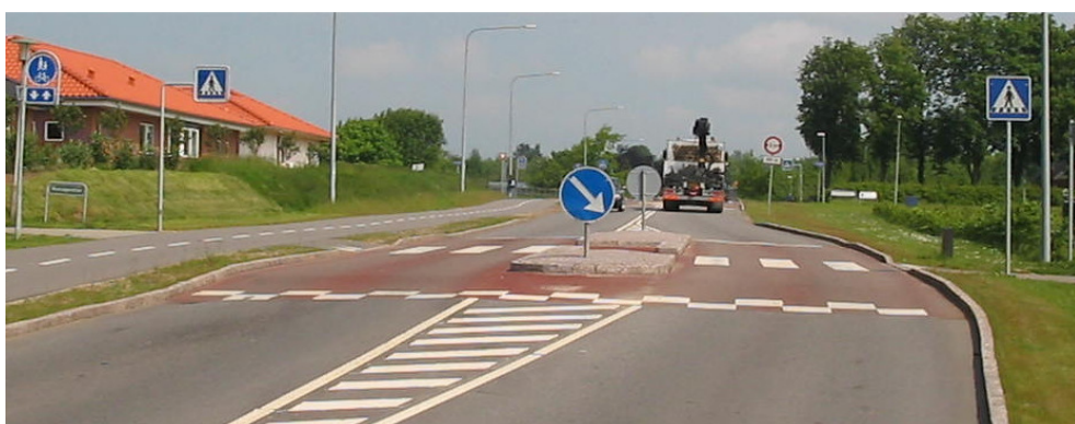
Figur 17 Eksempel på en hævet flade med krydsningshelle (foto fra Jelling). Den hævede flade kan også etableres uden krydsningshelle. Hævede flader sikrer, at biltrafikken tvinges ned i hastighed på det sted, hvor de lette trafikanter skal krydse vejen.
